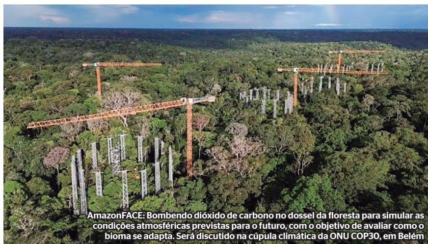
AmazonFACE, composto por seis anéis FACE, sendo três deles tratamento, com atmosfera enriquecida em CO 2 , e outros três anéis são controle, com a aspersão de ar ambiente
