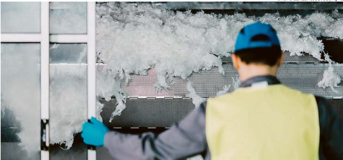
Linha de produção de fibras especiais de celulose (lyocell) em unidade do grupo Lenzing, na Áustria
