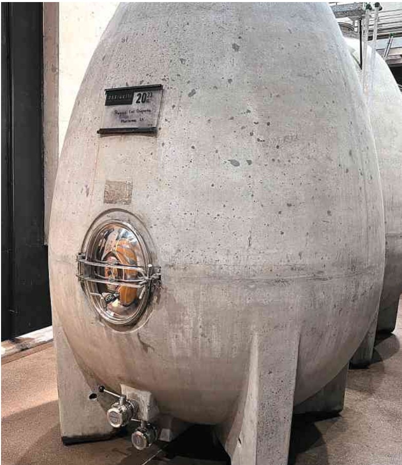
Tanque de fermentação feito de concreto na vinícola Durigutti
