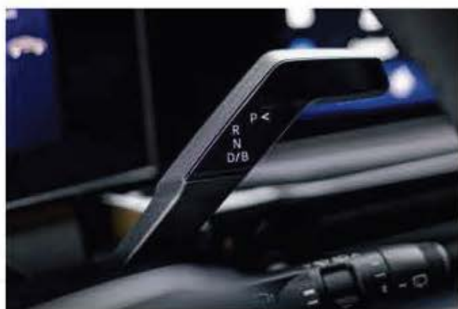
Monopla de câmbio da nova geração do Renault Clio fica acoplada na coluna de direção
