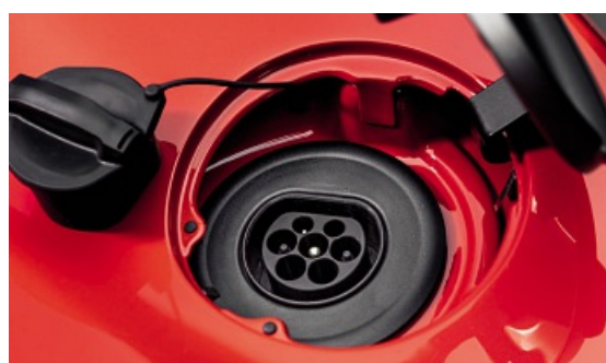
Apesar de toda a tecnologia, recarga da bateria é feita apenas em corrente alternada (AC), do tipo lenta, a uma velocidade máxima de 7 kW; assim, o carregamento completa leva cerca de 1h15min
