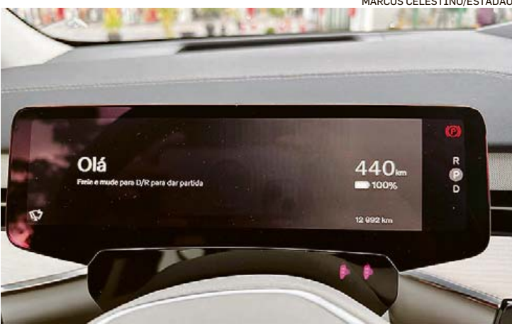
Motorista pode monitorar nível de carga no visor à frente do volante
