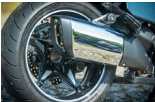
A bela roda traseira fica parcialmente escondida pela ponteira de escape; do outro lado, no monobraço, o eixo cardã
